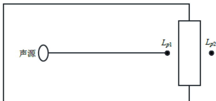
图 6.6-1 室内声源等效为室外声源图例
